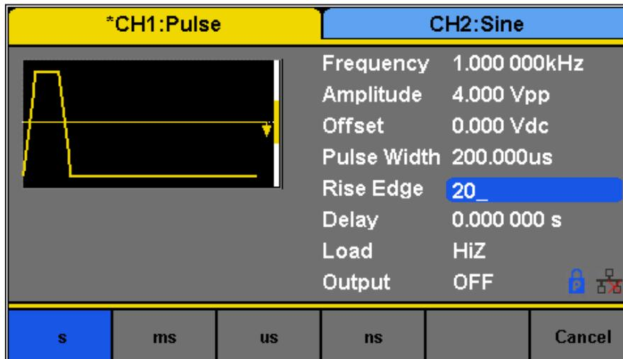
Figure 15 - Rise Edge of a Pulse
