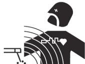
La corriente eléctrica causa campos electromagnéticos (EMF) localizados al pasar por cualquier conductor. La corriente de soldadura produce un campo electromagnético alrededor del circuito de soldadura y del material de soldadura.
