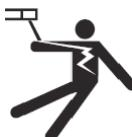
Het elektrische netwerk dat gebruikt wordt moet altijd geaard zijn. Gebruik het op de veiligheidstabel aanbevolen type zekering. Een elektrische schok kan, direct of indirect, ernstige en zelfs dodelijke ongelukken veroorzaken.
