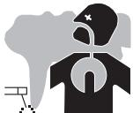
I fumi, i gas e le polveri emesse dal taglio sono pericolosi per la salute. È necessario prevedere una ventilazione sufficiente e a volte è necessario un apporto d'aria. Una maschera ad aria fresca potrebbe essere una soluzione in caso di aerazione insufficiente. Verificare che l'aspirazione sia efficace controllandola in relazione alle norme di sicurezza.
