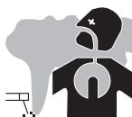
Les fumées, gaz et poussières émis par le coupage sont dangereux pour la santé. Il faut prévoir une ventilation suffisante, un apport d'air est parfois nécessaire. Un masque à air frais peut être une solution en cas d'aération insuffisante. Vérifier que l'aspiration est efficace en la contrôlant par rapport aux normes de sécurité.
