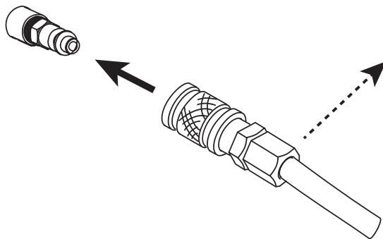
Raccorder l'alimentation en gaz à la source de courant à l'aide d'un tuyau à gaz inerte d'un diamètre interne de 9,5 mm et d'un coupleur à raccord rapide.
