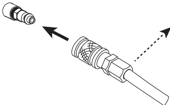
Koppel de gastoever aan aan de voedingsbron met behulp van een gasslang (inert gas) met een binnendiameter van 9,5 mm en een snelkoppeling.
