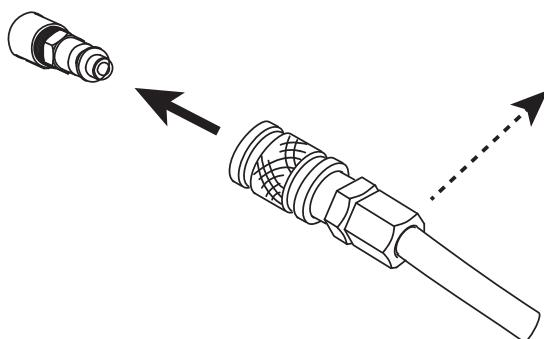
Gasversorgung über einen Inertgasschlauch mit Innendurchmesser 9,5 mm und einer Schnellkupplung an die Stromquelle anschließen.
