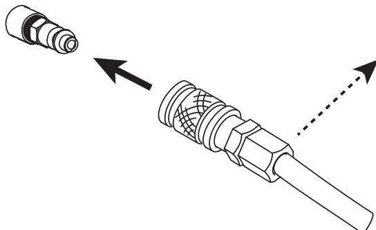
Collegare l'alimentazione gas alla fonte di corrente per mezzo di un tubo a gas inerte di diametro interno di 9,5 mm e di un commutatore a raccordo rapido.
