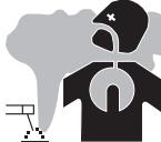
Beim Plasmaschneiden entstehen Rauchgase bzw. giftige Dämpfe, die zu Sauerstoffmangel in der Atemluft führen können. Sorgen Sie daher immer für ausreichend Frischluft, technische Belüftung (oder ein zugelassenes Atmungsgerät). Verwenden Sie die Schneidanlagen nur in gut belüfteten Hallen, im Freien oder in geschlossenen Räumen mit ausreichend starker Absaugung, die den aktuellen Sicherheitsstandards entspricht.
