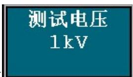
进入电压设定界面，用户可以根据需求输入0.1-6kV的测试电压
