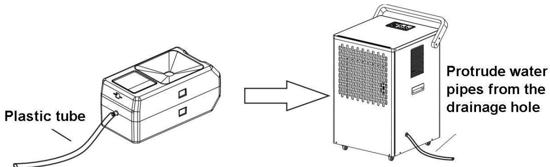
Đầu tiên, bạn lắp ống thoát nước vào cổng thoát nước bên hông bình xả thải, sau đó đặt bình xả thải trở lại máy hút ẩm. Lưu ý rằng, đầu ra của ống nước nên mở rộng ra khỏi lỗ thoát nước của máy hút ẩm.
