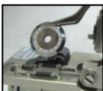
2. 按調整刀片高度進行調節刀片的高低。
