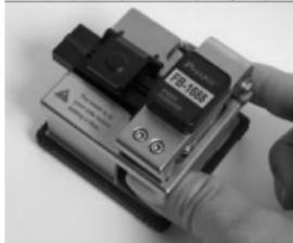
5. 打開蓋板及壓纖板，取出光纖；光纖取出後光纖端面請勿接觸任何物體，以免損壞光纖。
