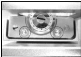
2. 微调右图所示的螺丝。顺时针方向调为升高刀片，反之为降低刀片高度。
