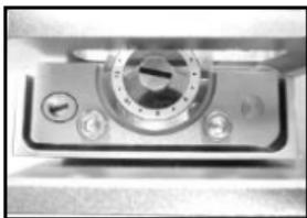
3. 采用内六角扳手，将刀片下方的两颗内六角螺丝锁紧
