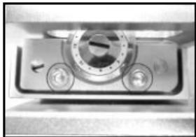
2. 微調右圖所示的螺絲。順時針方向調為升高刀片，反之為降低刀片高度。
