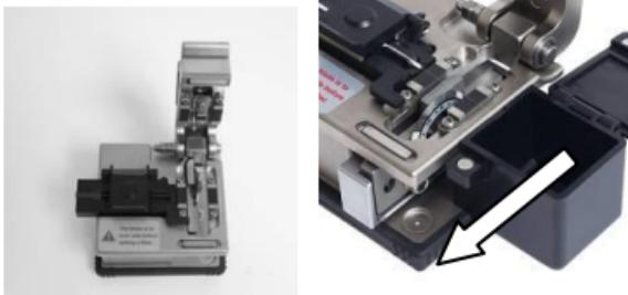
2. 将剥除好涂覆层的裸光纤放置于夹具内（ $250\mu\text{m} / 900\mu\text{m}/\Phi 3\text{mm}$  光纤/ $3\times 2$  皮线），根据使用者需要确定好切割长度。按下合上压纤板及盖板固定光纤。
