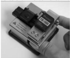
5.打开盖板及压纤板，取出光纤；光纤取出后光纤端面请勿接触任何物体，以免损坏光纤。
