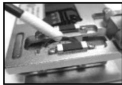
4. 完成後將刀片固定如仍然無法正常切割，需要按以下步驟調整刀片及切割滑塊的高度。
