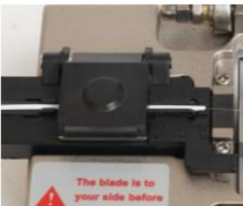
3.关上盖板后确保光纤处于水平在线。
