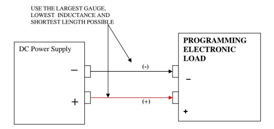
FIGURE 2.3 LOCAL SENSE CONFIGURATIONS
