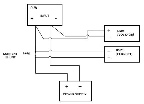
FIGURE 5.1 - CALIBRATION SETUP CONFIGURATION
