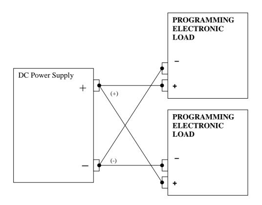
FIGURE 2.5 PARALLEL CONFIGURATION
