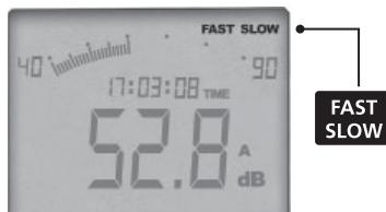
Das Gerät verfügt über zwei unterschiedliche Messintervalle. Bei Signalen, die sich schnell verändern, sollte die Zeitbewertung "FAST" eingestellt werden. Bei kontinuierlichen Signalen, die sich langsam verändern, sollte die Zeitbewertung "SLOW" eingestellt werden. Der Messintervall bei "FAST" beträgt 125 Millisekunden, bei "SLOW" 1 Sekunde. Durch Drücken der Taste "FAST/SLOW" kann die Zeitbewertung während der Messung jederzeit umgeschaltet werden.
