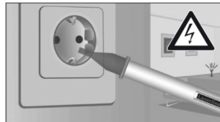
Je-li přítomno napětí, rozsvítí se hrot detektoru.
