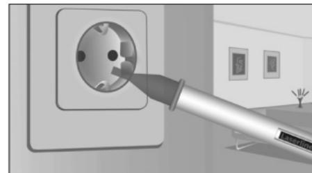
Ist Spannung vorhanden, leuchtet die Detektorspitze.
