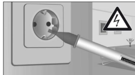
Dacă există tensiune, vârful detector luminează.
