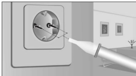
Setzen Sie die Detektorspitze auf den zu prüfenden Bereich (z.B. Kabel, Steckdose, etc.).
