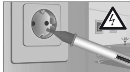
При наличии напряжения щуп загорается.
