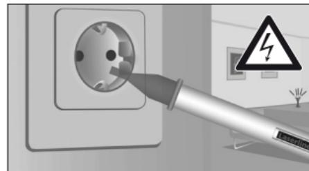
Hvis der findes en spænding, lyser detektorspidsen.
