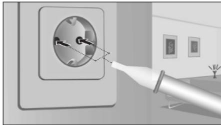
Pange detektoritipp kontrollitavasse piirkonda (nt kaabel, pistikupesa vms).
