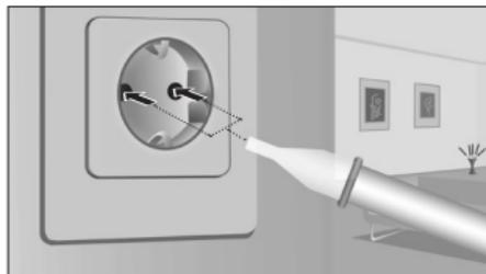
Poser la pointe du détecteur sur la zone à contrôler (par ex. câble, prise, etc.).
