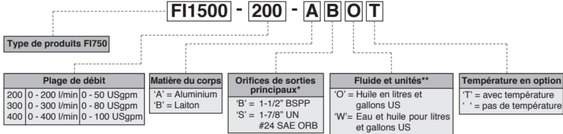
\* Manomètres à utiliser - Orifice principal 'B' - Filetage 1/4" BSPP
