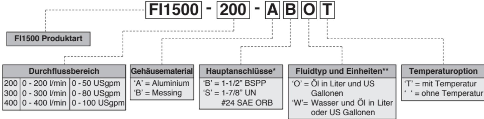
\* Manometeranschluss folgt dem Hauptanschluss - 'B' Hauptanschluss - 1/4" BSPP Manometeranschluss
