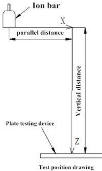
Ion bar length : 385mm ; Working frequency : 30Hz ;
