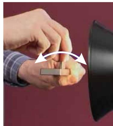
光が漏れてくる場合は、検査に不適切なので、新しいものと交換してください。
