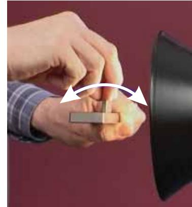
Als u licht ziet, is de schraper niet geschikt voor gebruik en dient u die te vervangen.
