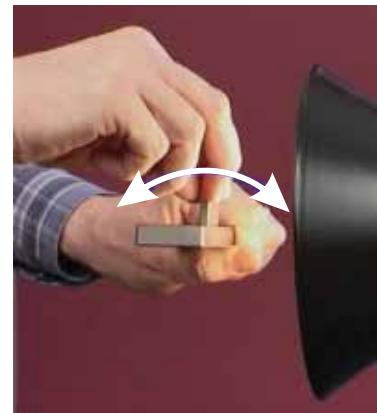
Si se ve luz, el rascador no es adecuado para su uso y deberá ser sustituido.
