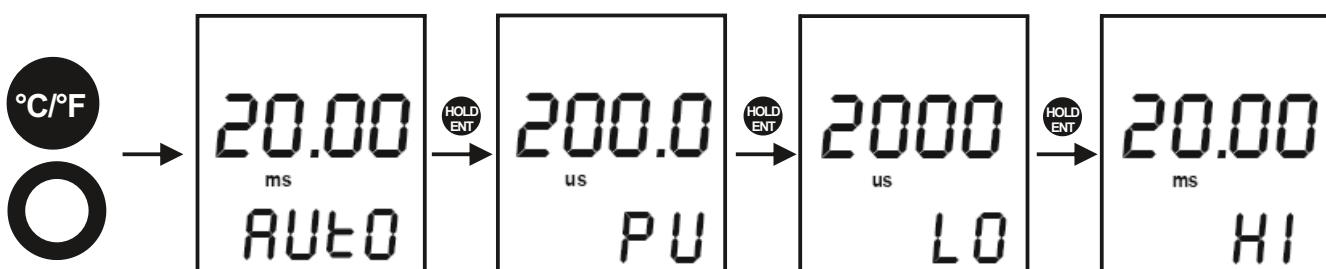
De meter kiest automatisch het laatst geselecteerde bereik als er niet binnen 5 seconden op een knop wordt gedrukt.
