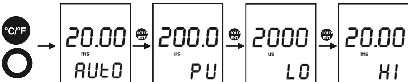
Wenn fünf Sekunden lang keine Taste betätigt wird, wird der zuletzt gewählte Bereich automatisch bestätigt.
