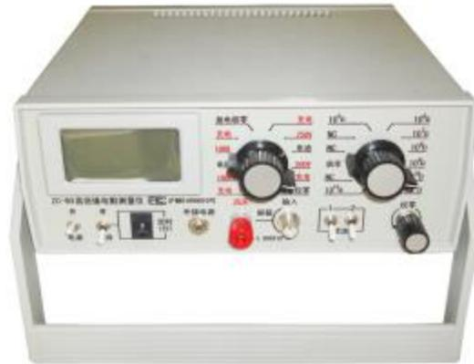
ZC-90 系列绝缘电阻测试仪是便携式数字显示高阻测试仪器,是测试电线电缆以及其它电工制品绝缘电阻的理想设备,与同类产品相比有以下几个特点:
